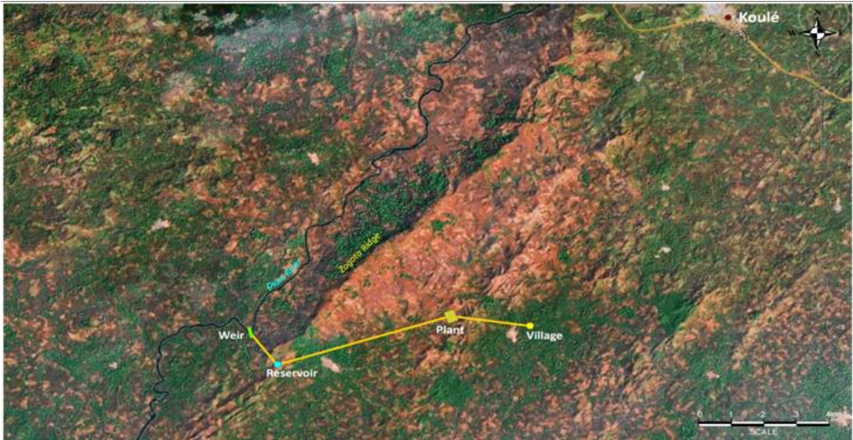
Figure 5.23 Plan conceptuel pour l'approvisionnement en eau sur le site de l'usine et le village de la mine
